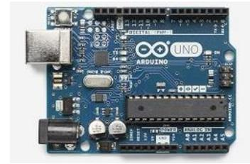
Gambar 3.2 Mikrokontroler Arduino UNO
