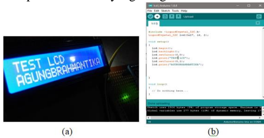
Gambar 4.4 (a)Tampilan LCD Setelah Diprogram (b) Tampilan Script Program
