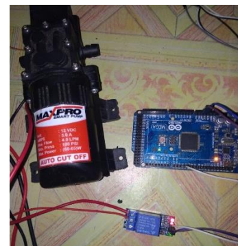
Gambar 4.6 Pengujian Pompa Air DC
