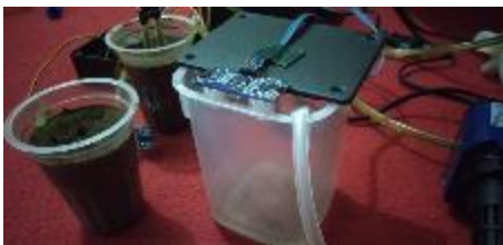
Gambar 29 Ketinggian Air 0 Pompa Air Menyala
