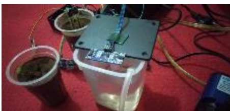
Gambar 30 Ketinggian Air 95 Pompa Air Berhenti
