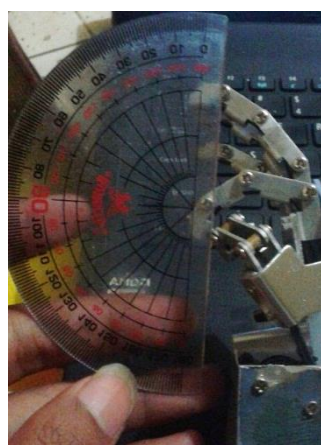
Gambar 4.33 kelengkungan jari robot ketika flex 90° jari robot
