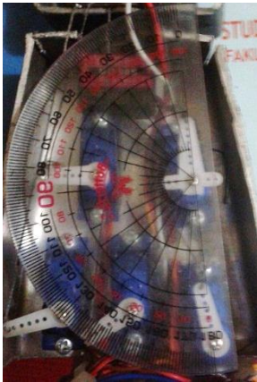
Gambar 4.38 posisi servo ketika flex 0° servo berputar 0°
