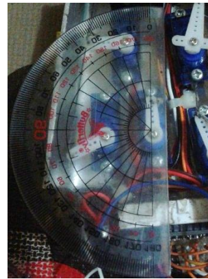
Gambar 4.34 posisi servo ketika flex 0° servo berputar 0°
