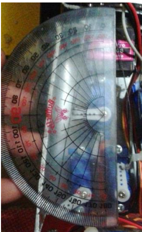
Gambar 4.32 posisi servo ketika flex 90° servo berputar 90°
