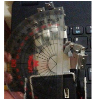
Gambar 4.29 kelengkungan jari robot ketika flex 90° jari robot melengkung 80°
