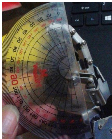
Gambar 4.31 kelengkungan jari robot ketika flex 0° jari robot melengkung 20°.
