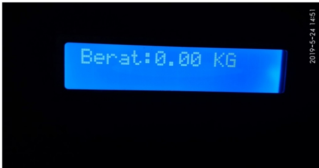
Gambar 4.2 Pengujian Load Cell pada saat tanpa beban dengan tampilan LCD
