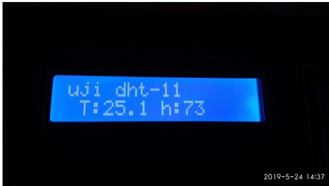
Gambar 4.1 Pengujian Sensor Suhu dan Kelembaban dengan tampilan LCD
