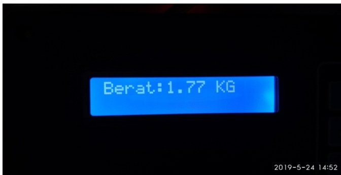
Gambar 4.3 Pengujian Load Cell pada saat ada beban dengan tampilan LCD
