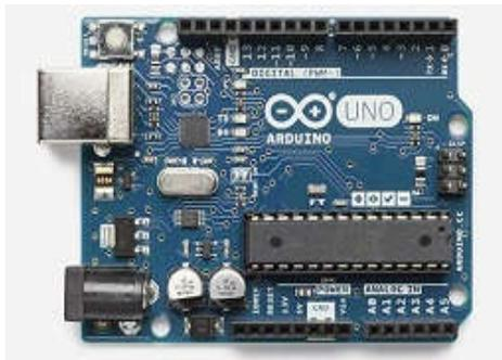
Gambar 3.2 Mikrokontroler Arduino Uno
