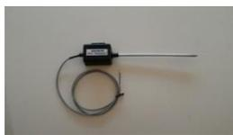
Gambar 2.2 Sensor pH tanah
