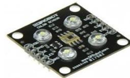
Gambar 2.4 sensor warna TCS3200
