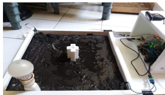
Gambar 14. Pengujian Respon Sensor Soil Moisture untuk Pompa Air
