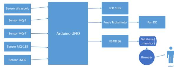
Gambar 3. 1 Diagram Blok Sistem pengendali kualitas udara
