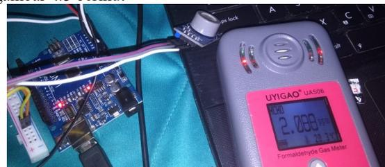
Gambar 4.5 hasil uji sensor MQ 7
