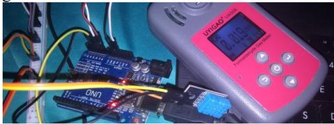
Gambar 4. 6 pengujian sensor suhu DHT11
