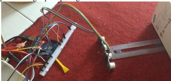
Gambar 4. 7 pengujian sensor ultrasonic
