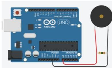
**Gambar 4.2** Rangkaian Pengujian Sensor Piezoelektrik
