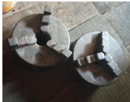
Gambar 3.6. Chuck bubut Sumber : Dokumen Pribadi
