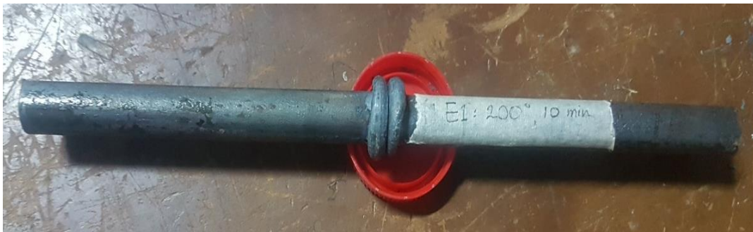
Gambar 4.2. Hasil Pengelasan Gesek Sumber : Dokumen Pribadi
