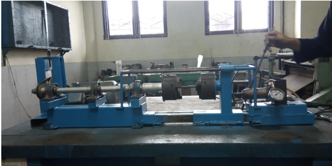
Gambar 4.1. Prototipe Las Gesek Sumber : Dokumen Pribadi
