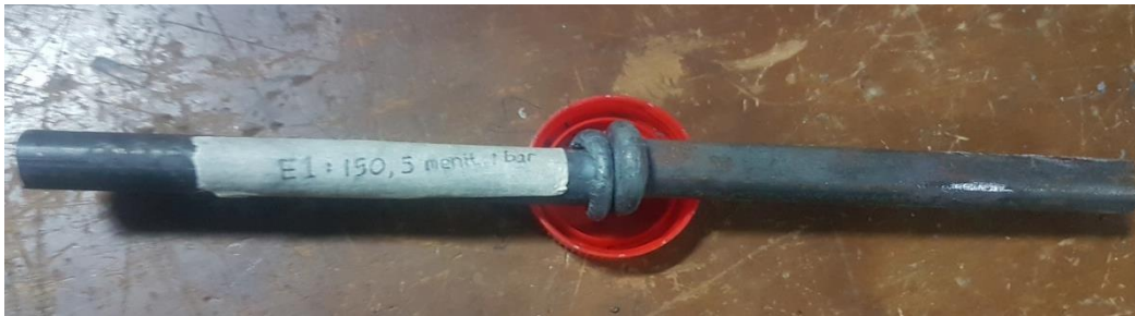
Proses Pemanasan Spesimen
