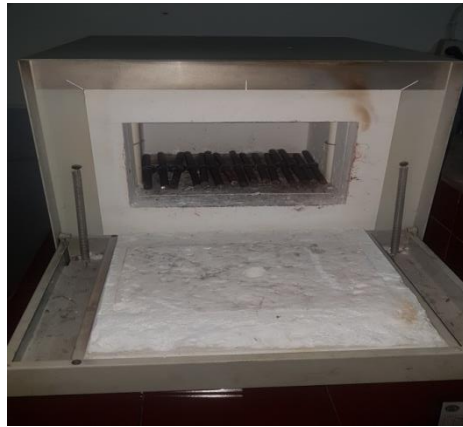
Proses Pemanasan Spesimen
