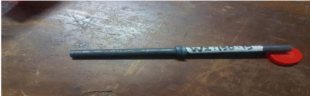
Spesimen Baja ST 37 keempat hasil pengelasan gesek (waktu penekanan 2 menit, pemanasan 150°C, dan holding 15 menit )
