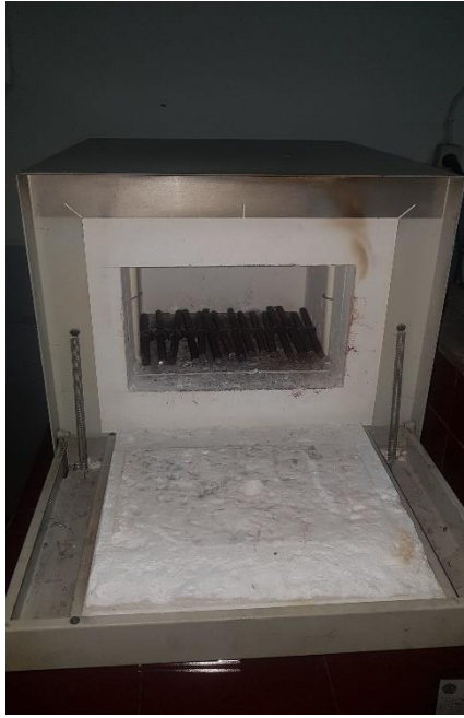
Pemanasan pada spcimen hasil pengelasan gesek
