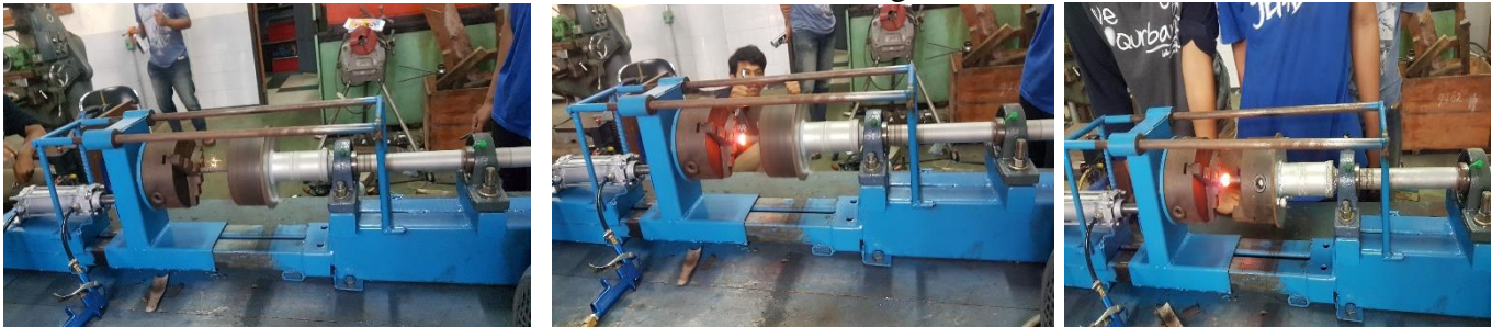
Proses Pengujian pada BAJA ST 37 dengan alat pengelasan gesek
