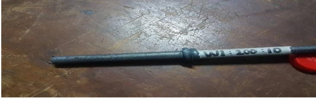
Spesimen Baja ST 37 ketiga hasil pengelasan gesek (waktu penekanan 1 menit, pemanasan 200°C, dan holding 10 menit )
