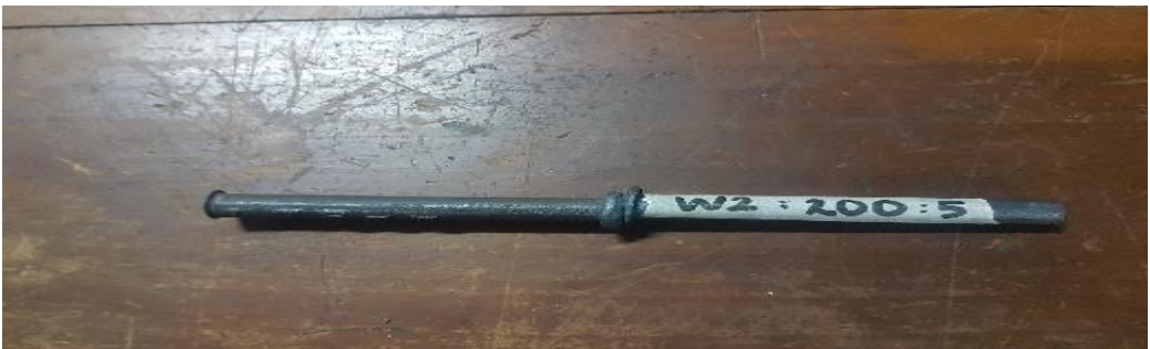
Spesimen Baja ST 37 kelima hasil pengelasan gesek (waktu penekanan 2 menit, pemanasan 200°C, dan holding 5 menit )
