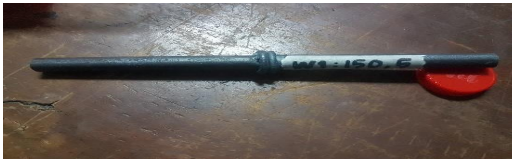
Spesimen Baja ST 37 pertama hasil pengelasan gesek (waktu penekanan 1 menit, pemanasan 150°C, dan holding 5 menit)
