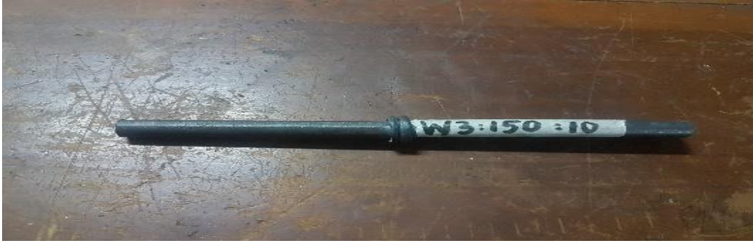
Spesimen Baja ST 37 ketujuh hasil pengelasan gesek (waktu penekanan 3 menit, pemanasan 150°C, dan holding 10 menit )
