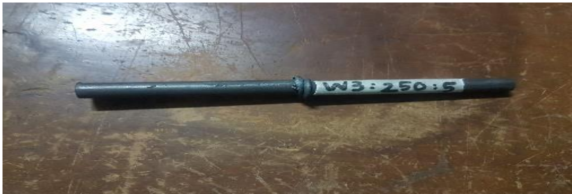
Spesimen Baja ST 37 kesembilan hasil pengelasan gesek (waktu penekanan 3 menit, pemanasan 250°C, dan holding 5 menit )
