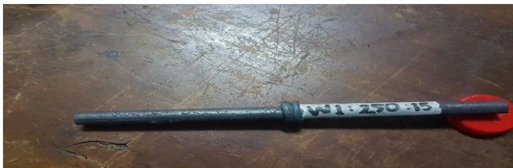
Spesimen Baja ST 37 kedua hasil pengelasan gesek (waktu penekanan 1 menit, pemanasan 250°C, dan holding 15 menit )
