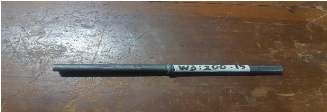
Spesimen Baja ST 37 kedelapan hasil pengelasan gesek (waktu penekanan 3 menit, pemanasan 200°C, dan holding 15 menit )
