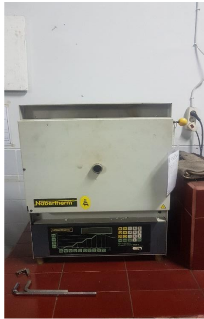
Pemanasan pada spcimen hasil pengelasan gesek
