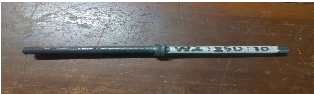
Spesimen Baja ST 37 keenam hasil pengelasan gesek (waktu penekanan 2 menit, pemanasan 250°C, dan holding 10 menit )
