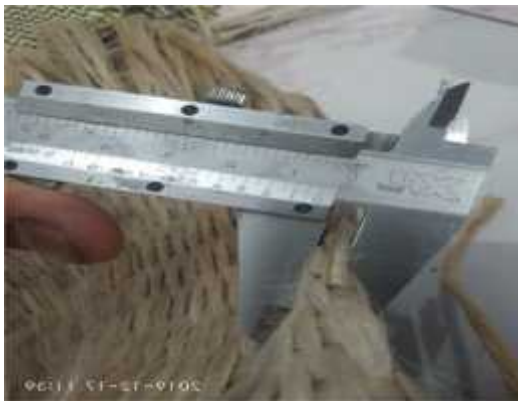
Gambar 3.34 Pengukuran ketebalan serat kenaf
