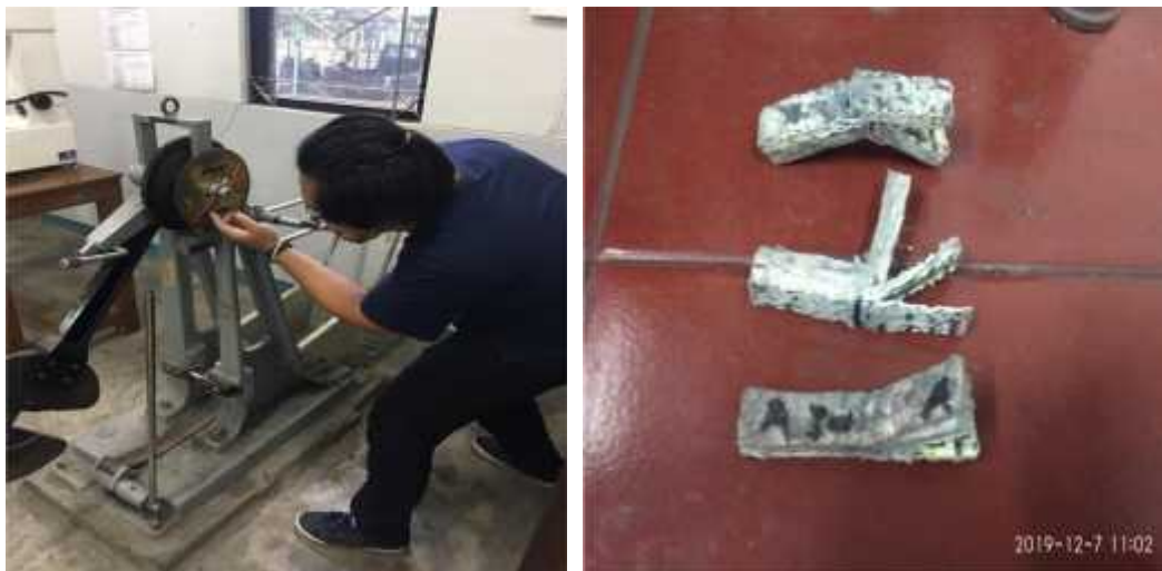
Gambar 3.48 proses pengujian impak
