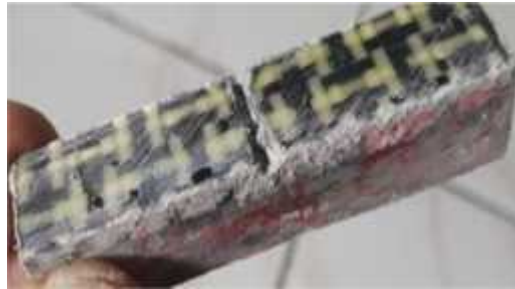
Gambar 3.47 spesimen telah di kikir.
