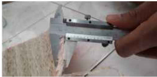
Gambar 3.36 Pengukuran ketebalan lapisan anyaman serat rami
