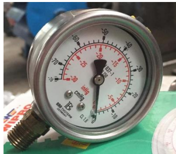
Gambar 3.18. Pressure Gauge Sumber: Dokumentasi Pribadi (2020)
