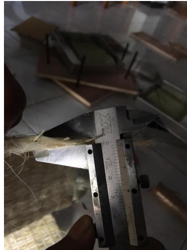
Gambar 3. 29 pengukuran serat agave
