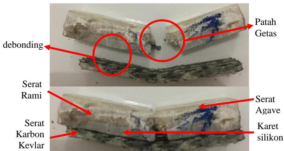
Gambar 4. 8 Foto patahan salah satu specimen 30% karet silikon
