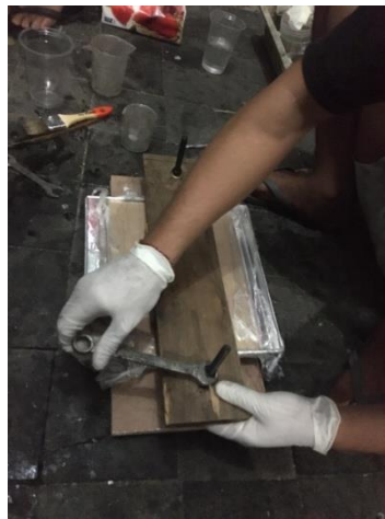
Gambar 3.30 Pemasangan alat press cetakan
