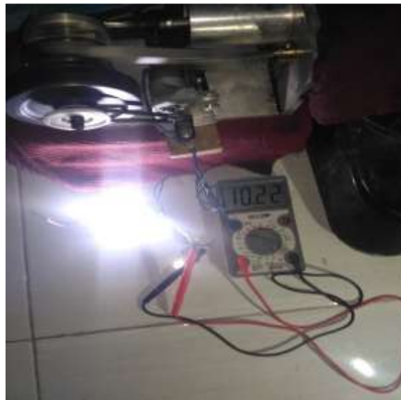
Gambar3. 19 Pengujian Komposisi ke 2 Pada sampel ke Tiga di dapatkan hasil tegangan listrik sebesar 10,22 volt Sumber: Dokumentasi Pribadi
