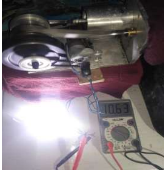
Gambar3. 14 pengujian komposisi 1 pada sampel pertama di dapatkan hasil tegangan listrik sebesar 10,63 volt Sumber : Dokumentasi Pribadi
