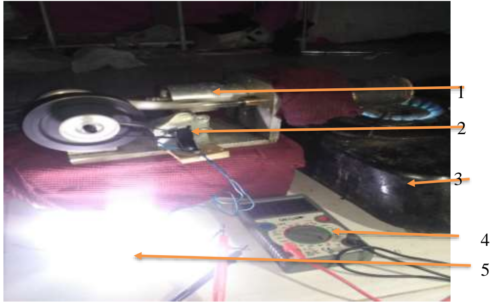
Gambar3. 13 Proses pengujian biogas pada motor stirling
