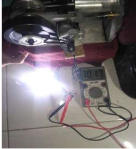
Gambar3. 18 Pengujian Komposisi ke 2 Pada sampel ke dua di dapatkan hasil tegangan listrik sebesar 10,17 volt Sumber: Dokumentasi Pribadi
