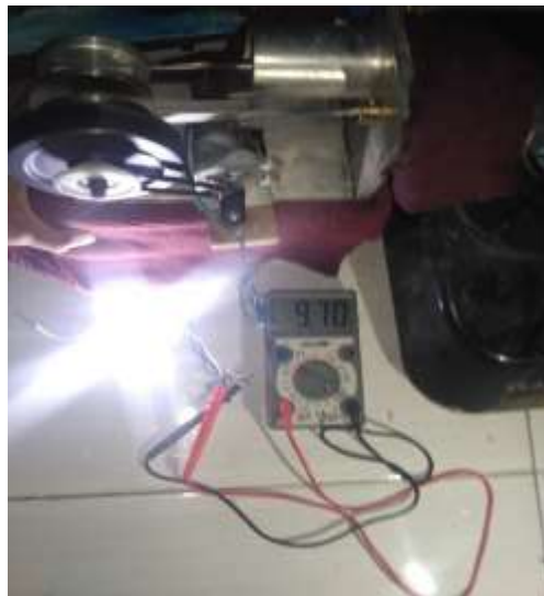
Gambar3. 21 Pengujian Komposisi Ke 3 pada sampel kedua di dapatkan hasil tegangan listrik sebesar 9,70 volt Sumber: Dokumentasi Pribadi
