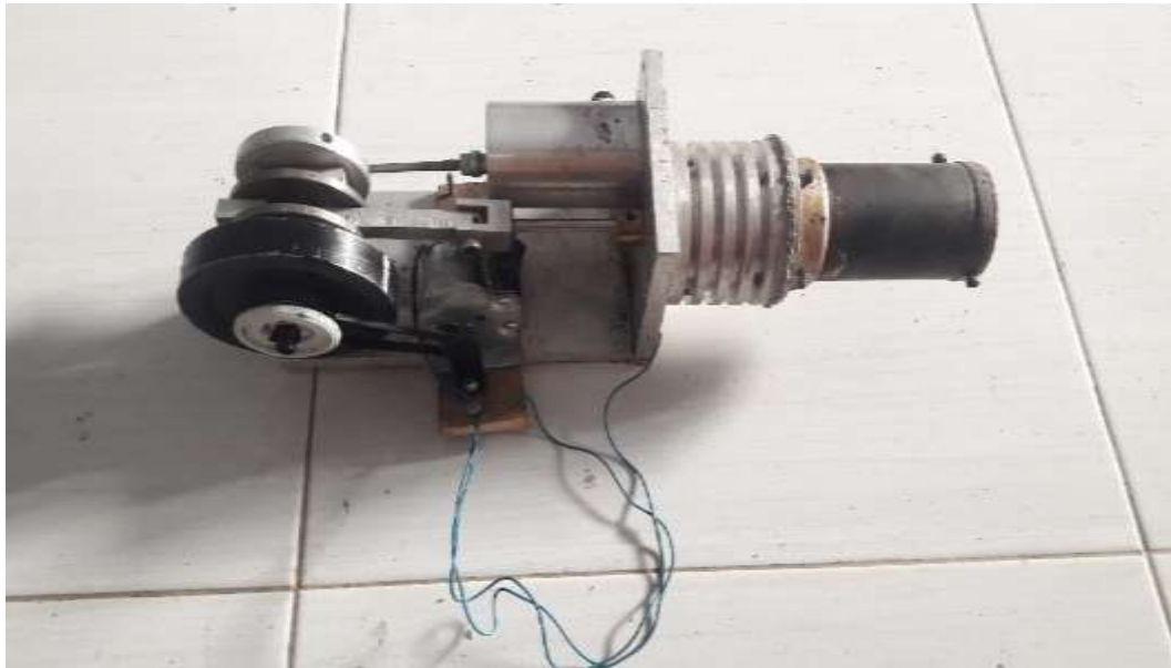
III-1 1 Mesin Stirling Tipe Gama
