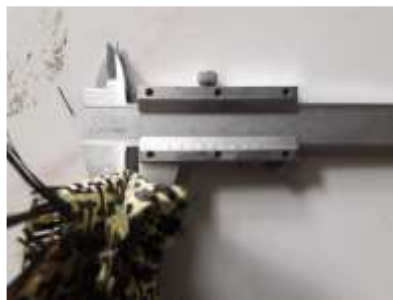
Gambar 3.28 Pengukuran Serat Karbon Kevlar
