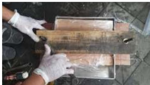
Gambar 3.38 Pemasangan Alat Press
