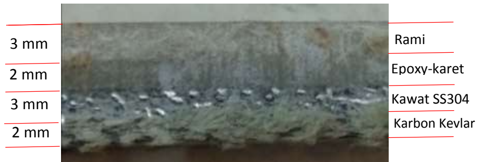
Gambar 3.40 Tebal Tiap Lapisan Komposit Laminasi
