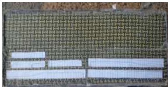
Gambar 3.39 Spesimen Komposit Setelah Pencetakan
