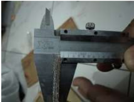
Gambar 3.30 Pengukuran Kawat SS304
