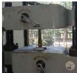
Gambar 3.47 Pemasangan Spesimen Ke Chuck Mesin
