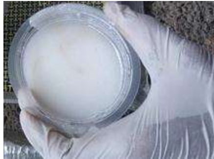
Gambar 3.34 Campuran Epoxy Dengan Karet Silikon
