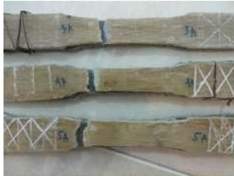
Gambar 4.1 Lokasi Patahan Spesimen Uji Tarik
