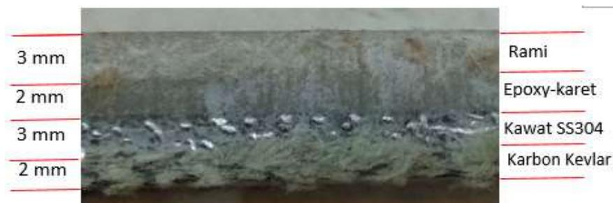
Gambar 3. Hasil Laminasi Spesimen Komposit
