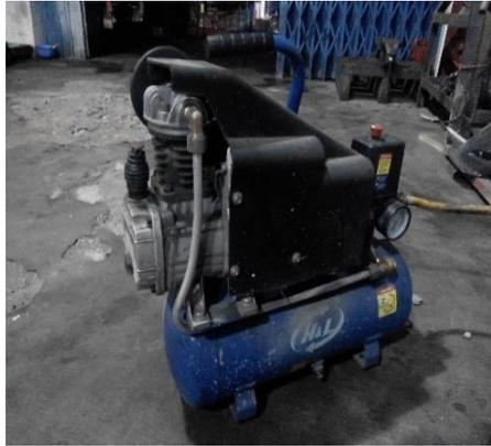
Gambar 3.11 Kompresor udara
