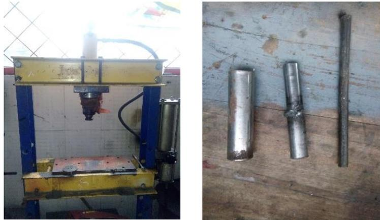
Gambar 3.9 Mesin press & Cetakan
