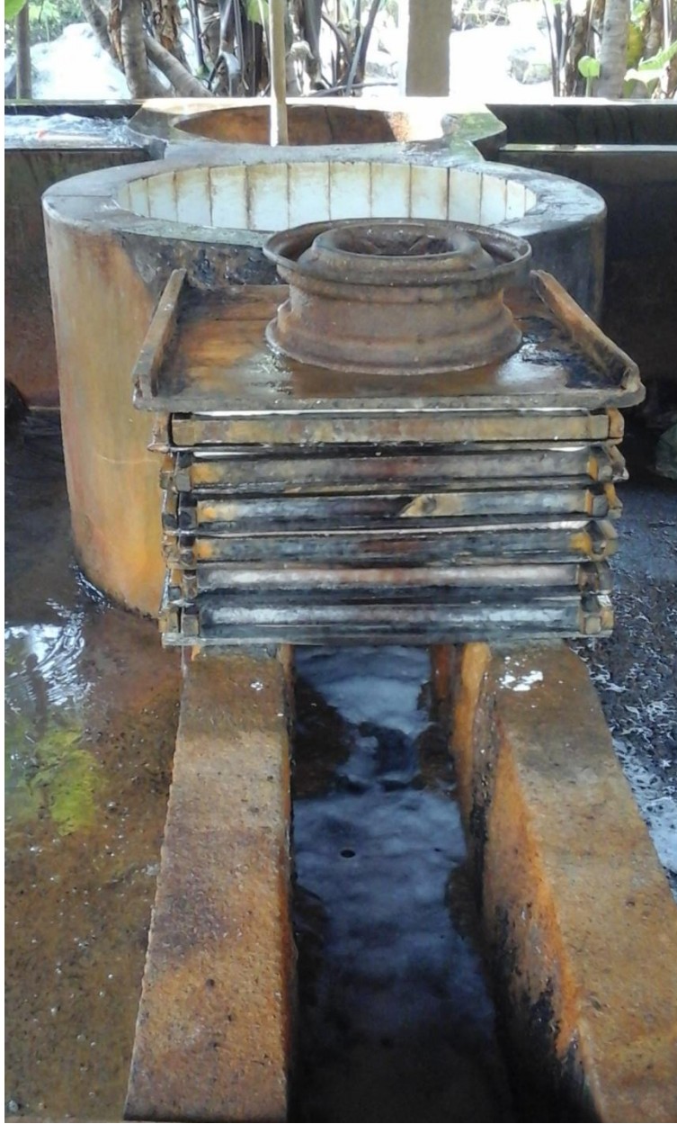
Proses pengepresan tahu
