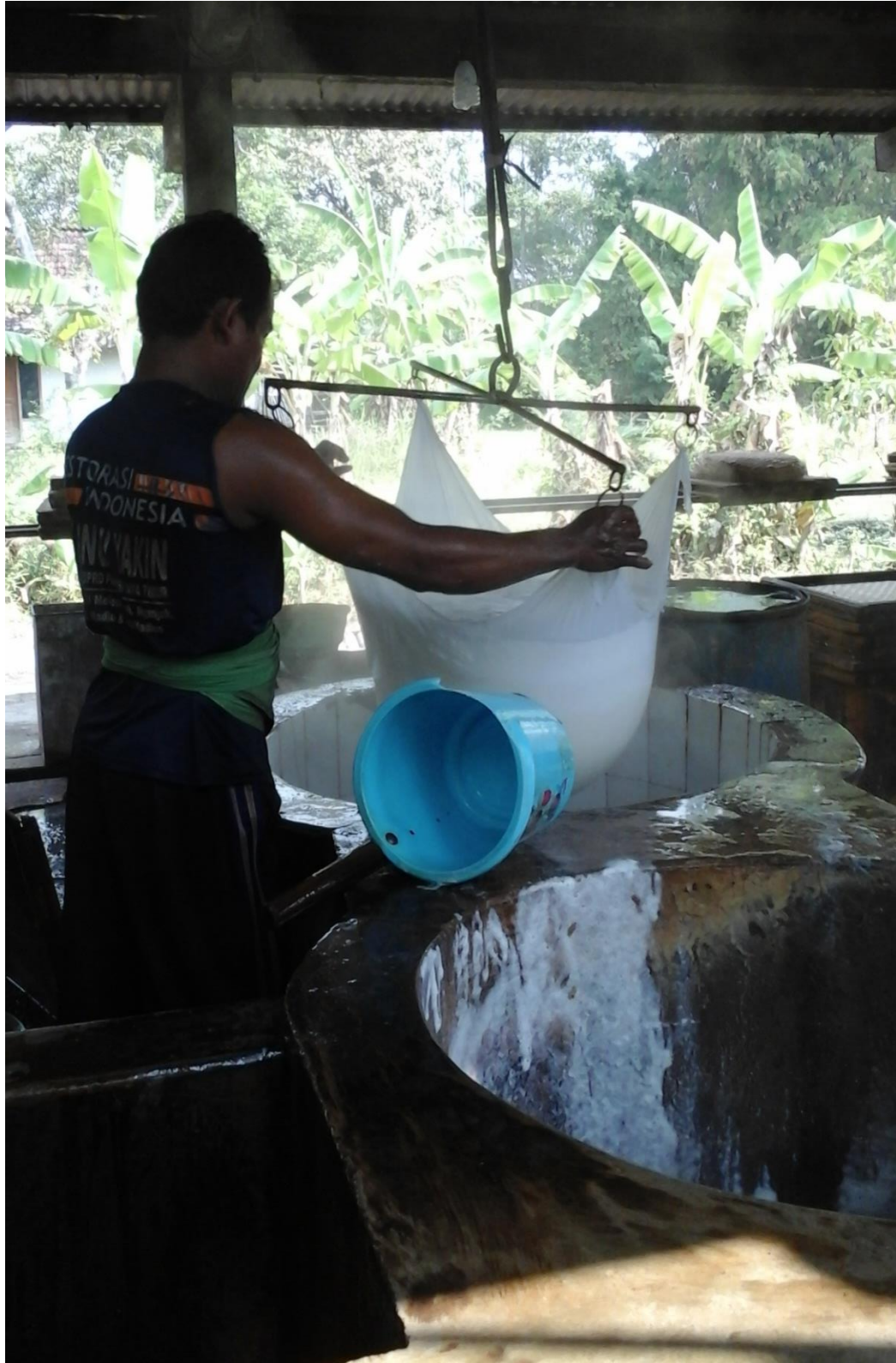
Proses pemisahan sari kedelai dengan ampas kedelai
