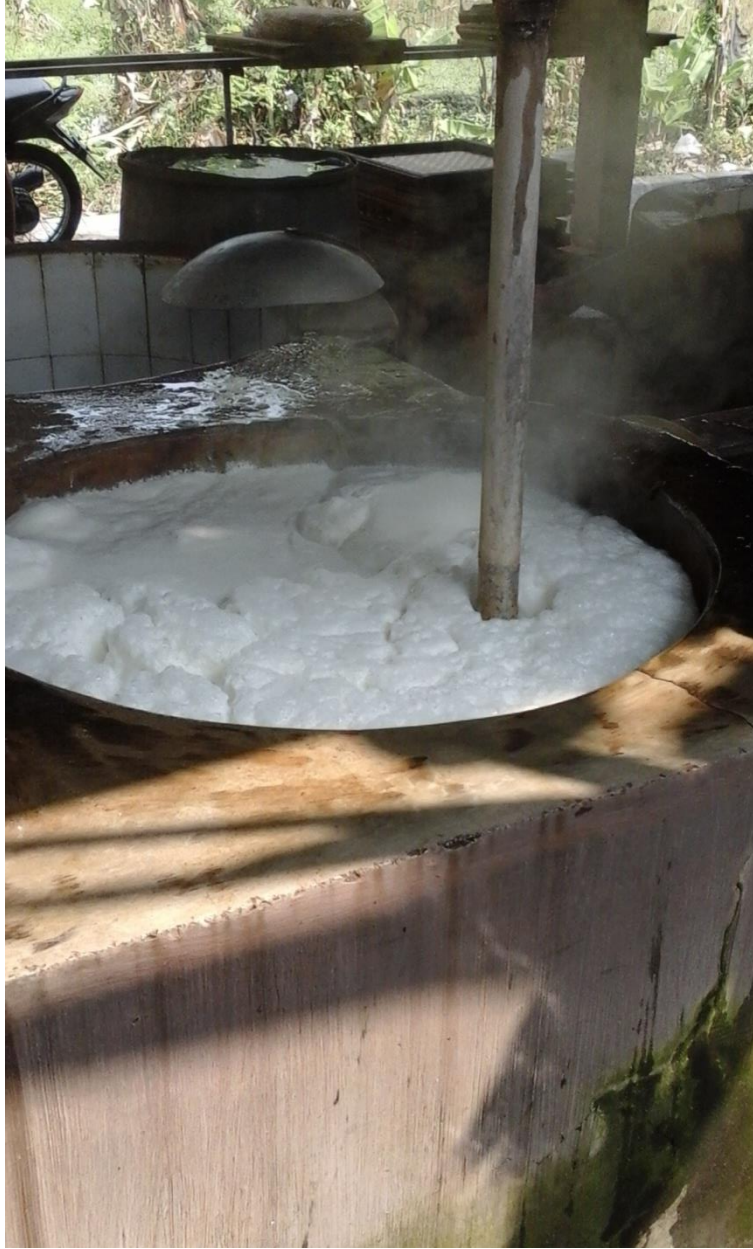
Pemasakan bubur kedelai dengan uap air
