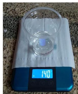
Gambar 3. 34 Proses penimbangan 70% dari 200 gram epoxy
