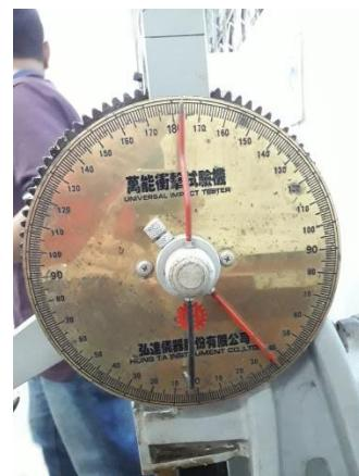
Gambar 3. 44 Proses pembacaan beta hasil pengujian
