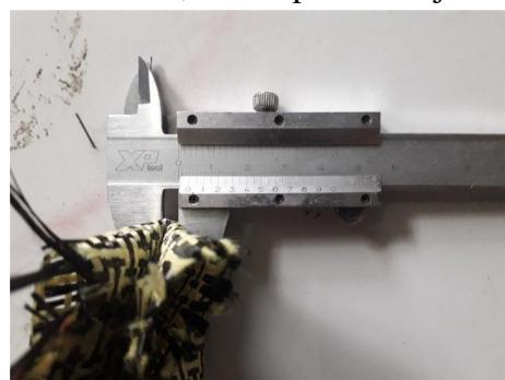
Gambar 3. 30 Pengukuran serat karbon Kevlar
