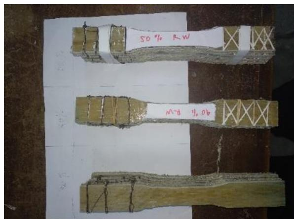
Gambar 3. 41 Spesimen uji tarik
