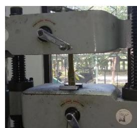
Gambar 3. 47 Pemasangan spesimen ke chuck mesin
