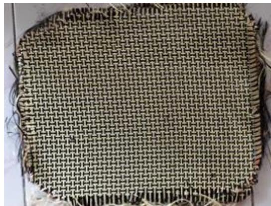
Gambar 3. 24 Serat karbon kevlar yang sudah dipotong
