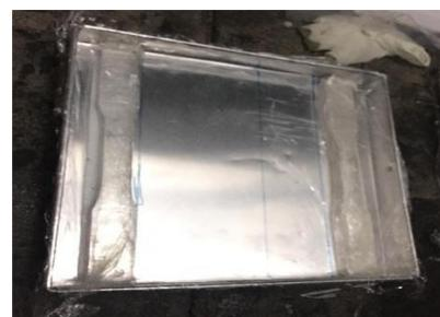
Gambar 3. 33 Loyang cetakan spesimen uji tarik dan impact
