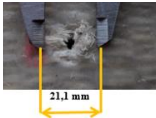
Gambar 12. Timbulan kerusakan material produk setelah uji tembak
