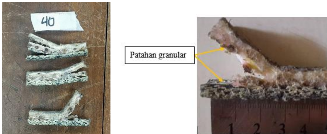
Gambar 7. kerusakan yang terjadi pada spesimen 40% karet silikon
