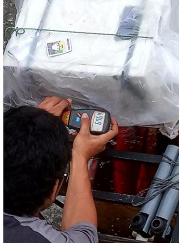
Gambar 3.21 Pengambilan Data Rpm Generator
