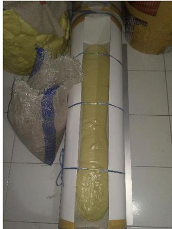
Gambar 3.19 Proses Pembuatan Pelampung
