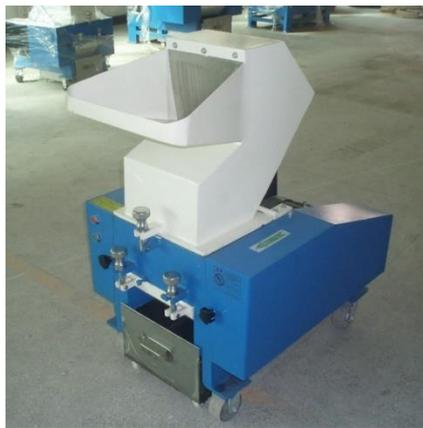
Gambar 2.1 Mesin Pencacah Plastik Tipe Crusher
