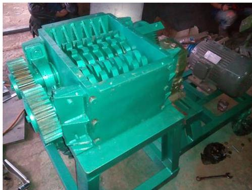
Gambar 2.2 Mesin Pencacah Plastik Tipe Shredder
