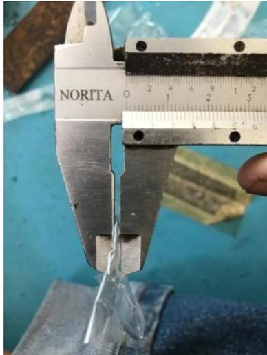
Gambar 3.8 plastik dengan ketebalan 0,3 mm
