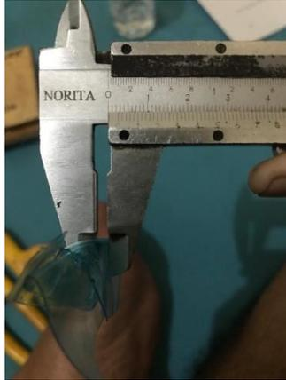
Gambar 3.10 plastik dengan ketebalan 0,7 mm.
