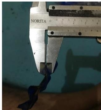
Gambar 3.9 plastik dengan ketebalan 0,5 mm
