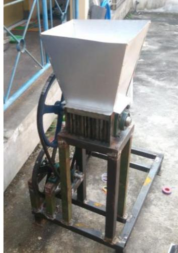
Gambar 3.2 Mesin Pencacah Plastik Tipe Crusher
