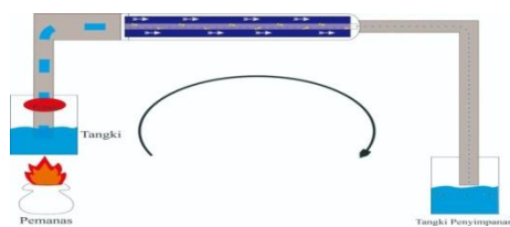
Gambar 2. Instalasi Alat Filtrasi Air Laut
