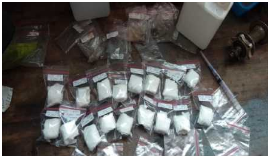
Pembungkusan Spesimen Setelah Dietsa Agar tidak Korosi
