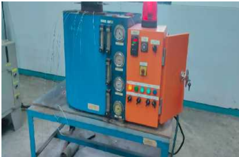
Reaktor Fluidized Bed Untuk Proses Nitridisasi di Laboratorium Teknik Mesin ITN Malang
