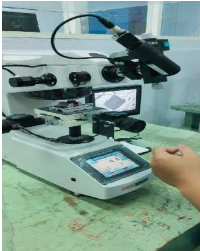
Uji Kekerasan Menggunakan Micro Vickers di Laboratorium Teknik Mesin Politeknik Negeri Malang
