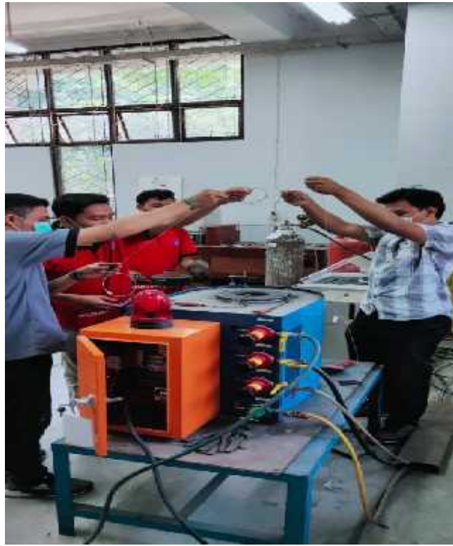
Proses memasukan spesimen ke dalam Reaktor Fluidised Bed
