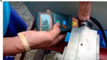
Gambar 2.8 Pengukuran putaran poros turbin dengan tachometer
