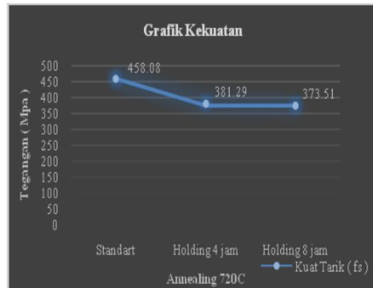
Gambar 6. Grafik tegangan pada uji tarik
