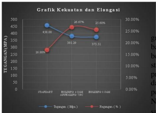
Gambar 8. Grafik perbandingan tegangan dan regangan
