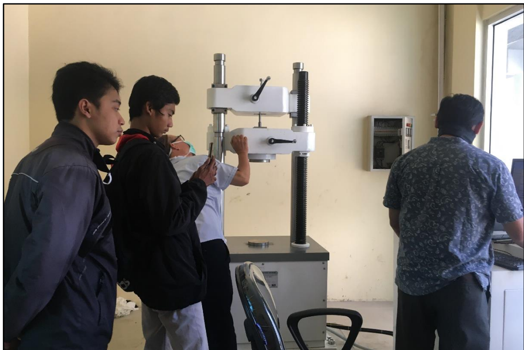
Gambar 12. Pengujian Kekuatan Tarik di Laboratorium Teknik Mesin Universitas Negeri Malang
