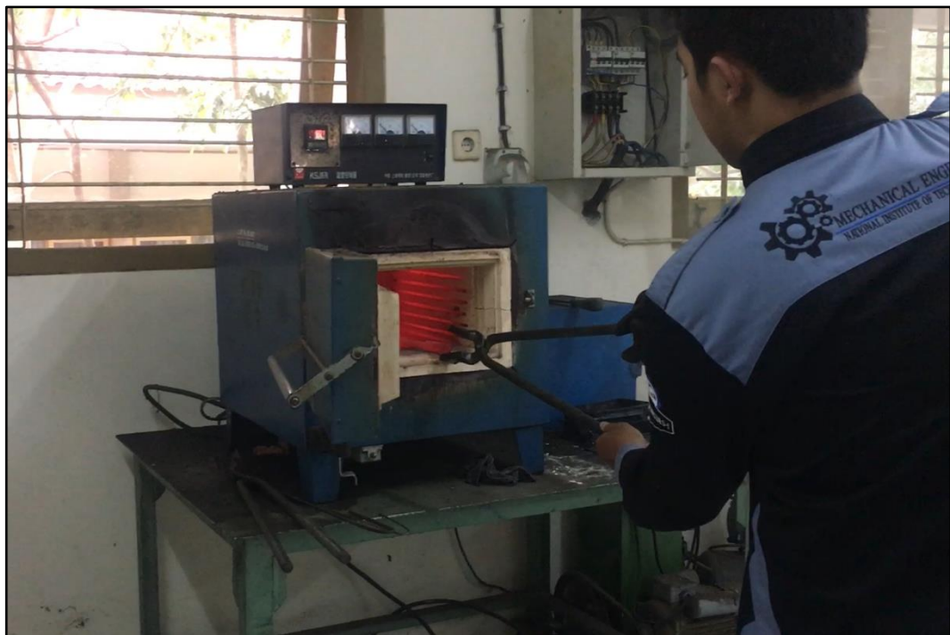
Gambar 6. Perlakuan Panas Hardening di Laboratorium Teknik Mesin Universitas Negeri Malang
