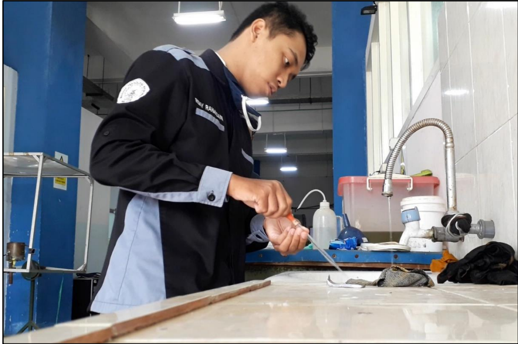
Gambar 7. Proses Etsa Pengujian Struktur Mikro di Laboratorium Bahan Teknik Mesin Politeknik Negeri Malang
