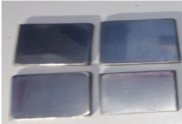
Material sebelum dilakukan sandblasting
