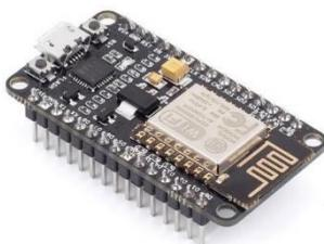
*Gambar 2. 6 Modul NodeMCU ESP8266*
