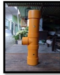
Gambar 2 Pipa Saluran Udara Mini Composter M3 (Dokumentasi, 2019)
