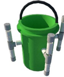
Gambar 2 Pipa Saluran Udara Mini Composter M3 (Dokumentasi, 2019)
