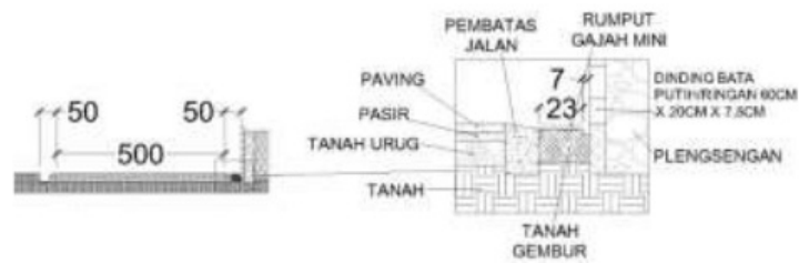
Gambar. 14 Potongan Selokan Yang Berfungsi Dengan Baik Sumber: Ujianto, 2019
