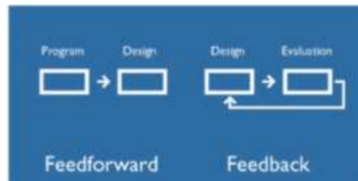
Gambar 4. Indikator Urutan Desain: Feedforward - Feedback Sumber: Pena & Parshall (2001)
