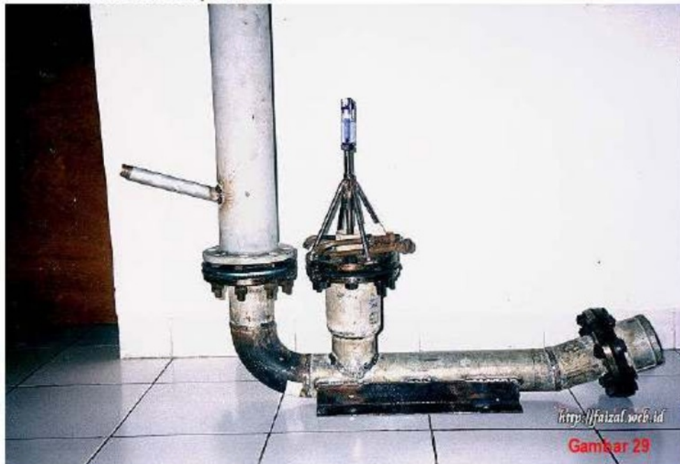
Gambar 28: Pipa keluaran untuk disambungkan dengan pipa PVC atau selang.
