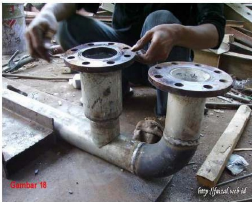
Gambar 15-18: Proses pembuatan tabung limbah pompa hidram
