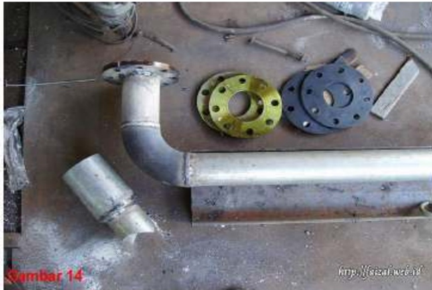
Gambar 11-14: Proses pembuatan badan pompa
