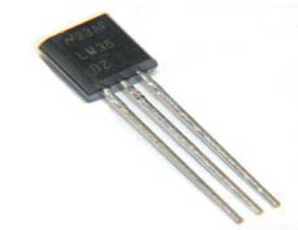
Gambar 2. 9LM35 Sensor suhu
