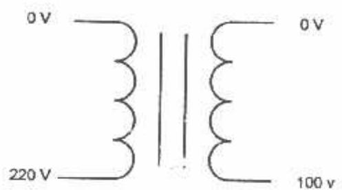
Gambar 2.7. Transformator Step down<sup>[1]</sup>
