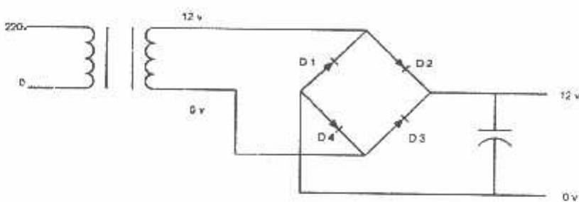
Gambar 3.5. Rangkaian Power Supply<sup>[11]</sup>
