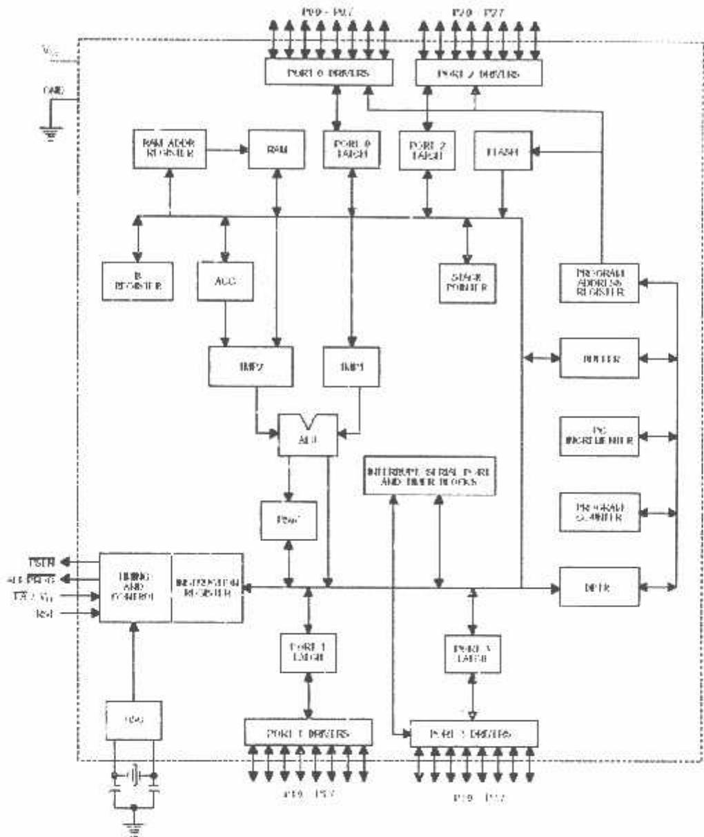
Gambar 2.1. Blok Diagram MCS -51<sup>(1)</sup>
