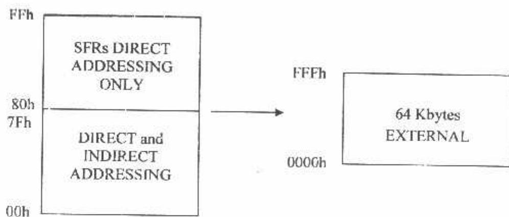
Gambar 2.3 Blok Diagram Data Memori<sup>10</sup>
