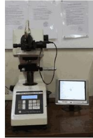
Gambar 5. Mesin uji kekerasan micro vickers
