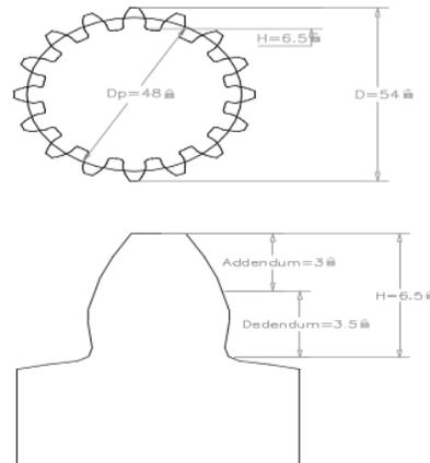
Gambar 1. Roda Gigi dan Lintasan pemotongan DIN 3 -16
