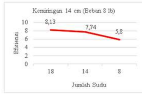
Gambar 6. Grafik efisiensi dengan jumlah sudu 18, 14 dan 8 menggunakan kemiringan 14 cm dengan beban 8 lb.
