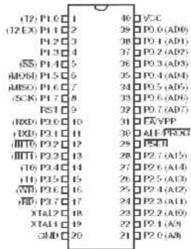
Gambar 2-2. Konfigurasi Pin-Pin AT89s8252
