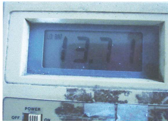
Gambar 4.8. Hasil tegangan penguat motor tanpa beban
