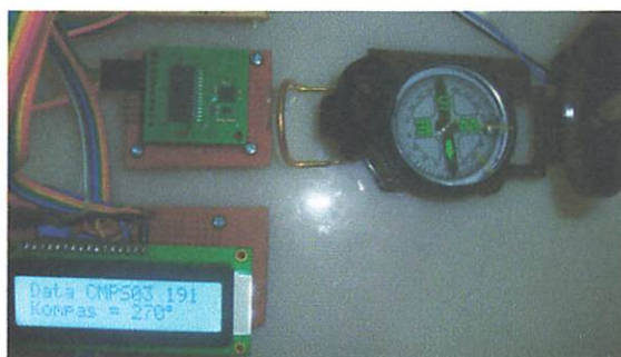
Gambar 4.3. Hasil Perbandingan Kompas Digital Dengan Kompas Analog
