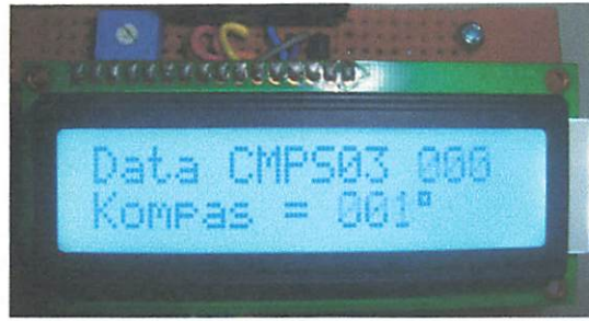
Gambar 4.2. Hasil Pengujian Kompas Digital CMPS03
