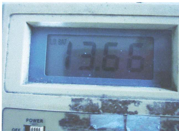
Gambar 4.10. Hasil tegangan penguat motor dengan beban
