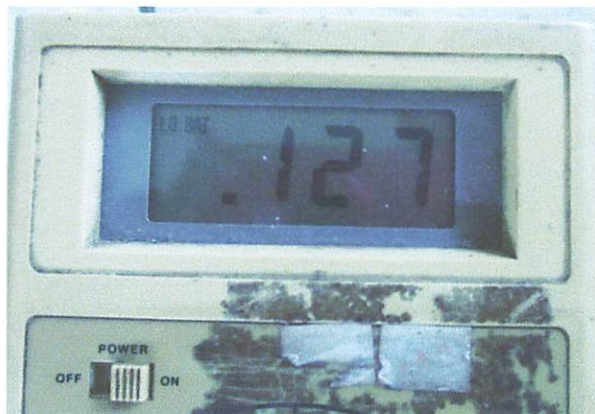
Gambar 4.9. Hasil arus penguat motor tanpa beban
